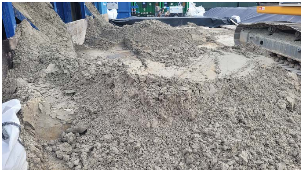
Sandiges Bohrklein aus den HDD-Bohrungen Norderney (Aufnahme 2023 S. Kemper)
